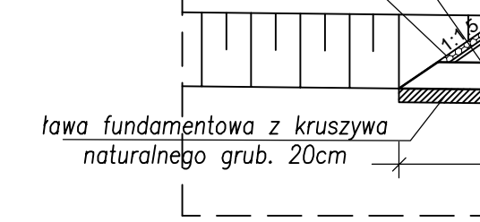
proj./istn. przepust z rur z tworzywa sztucznych Ø40 umocnienie brukiem na podsypce piaskowo-cementowej grub. 5cm
